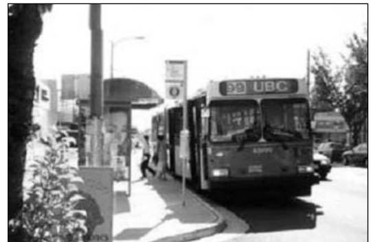
Figure 3-12 : Autobus utilisant la voie de circulation de transit pour accéder à l'arrêt d'autobus.
