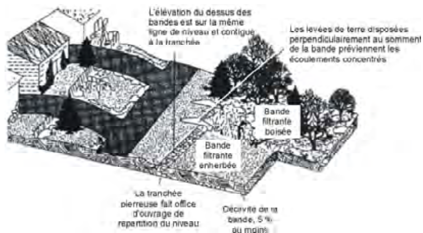
Figure 3-5 : Bandes filtrantes engazonnées et boisées. Source : Schueler (1987)
