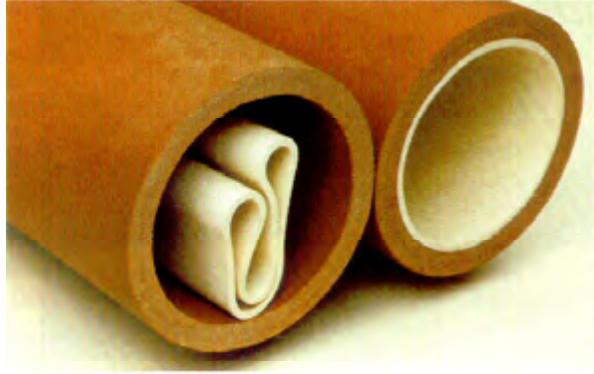
Figure 3-3 : Tubage ajusté (gaine en PVC pliée, pour rénovation de conduite d'égout, montrant la pose ajustée une fois la gaine inversée)
