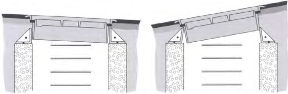
Cadre de guidage droit pour un revêtement incliné de 0 à 7 %
