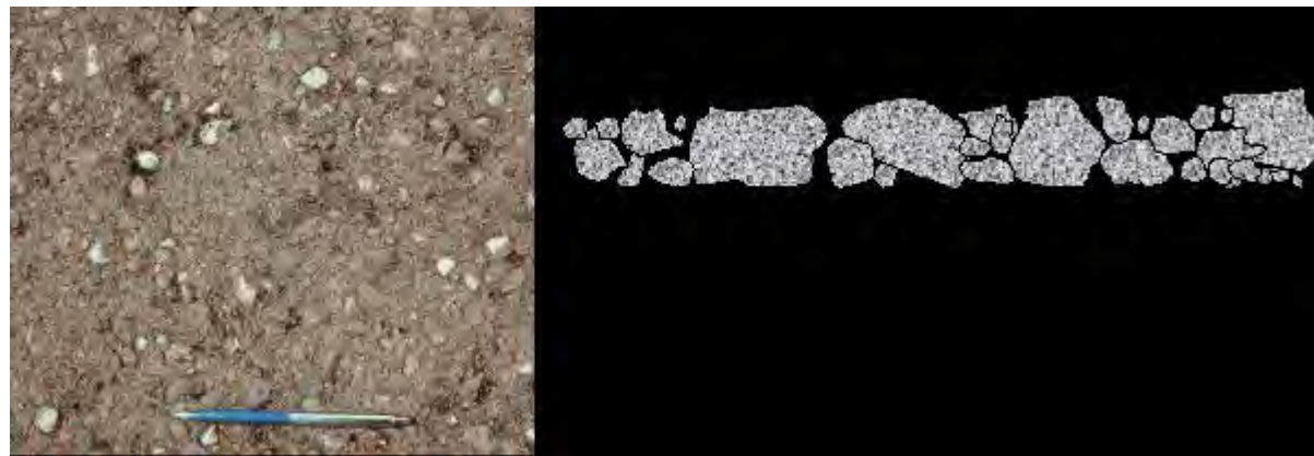
Figure 3–14 : Surface d'une couche de fermeture nouvellement construite à l'aide de fragments de 13,2 mm et d'une émulsion CRS–2P.
